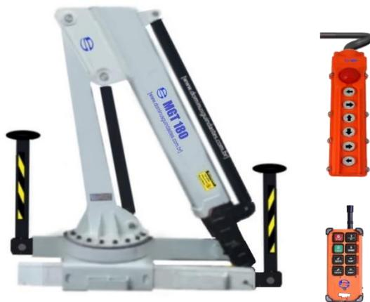
Este equipamento tem como característica sua funcionalidade que se dá através de uma central eletro-hidráulica de 12 volts acionada por controle remoto com fio. Permitindo ao usuário a montagem em pequenos utilitários que não oferecem saída para acoplamento de tomada de força, pode ser estacionário.
