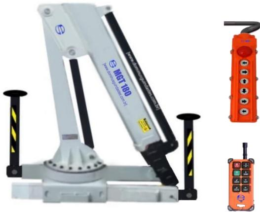
La funcionalidad de este equipo se caracteriza por una centralita electrohidráulica de 12 voltios activada por un mando a distancia con cable. Permitiendo al usuario montarlo en vehículos utilitarios pequeños que no dispongan de salida de acoplamiento para toma de fuerza, pudiendo ser estacionario.
